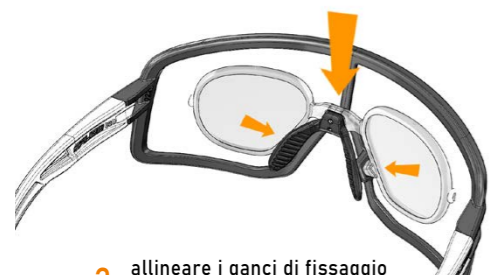
3 allineare i ganci di fissaggio align the hooks
